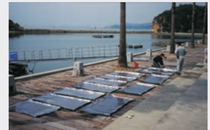
鉛板の縁を折り、海水をためて腐食させる。 Lead sheets with folded edges and soaked in seawater to corrode.
